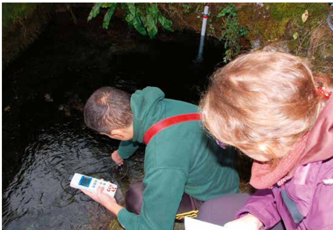
Durante le operazioni di sostituzione dei captori sono stati costantemente verificati i principali parametri fisico-chimici delle acque (foto M. Inglese)
